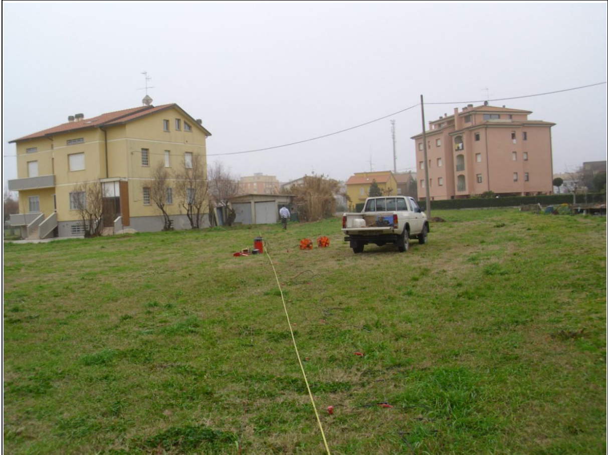
Fig. 5 – Ubicazione Prova MASW
