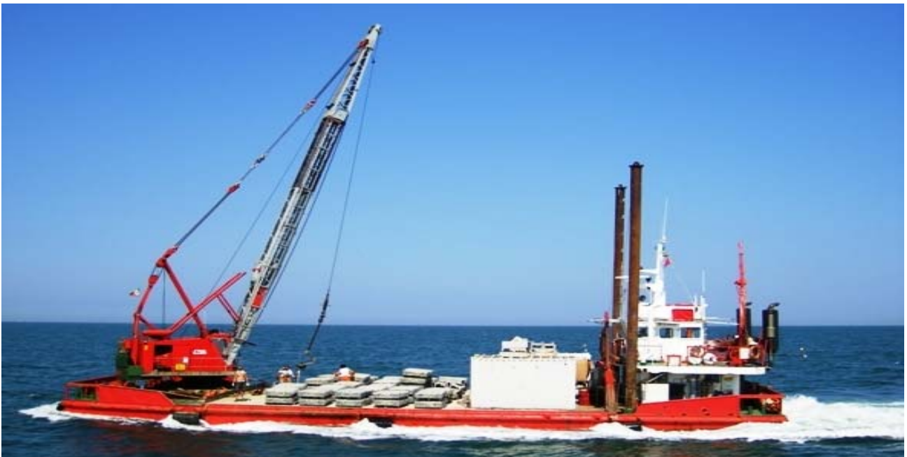
Fig. 6.1/1 - Esempio di motopontone che può essere impiegato per la posa di scogliere.
