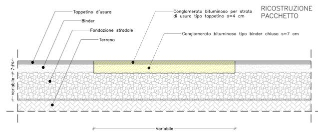
Sezione Tipo "B" : Ricostruzione del pacchetto bitumato
